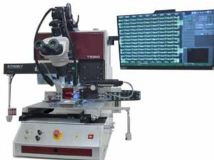
Machine T5100 intégrant la technologie Flip Chip (alignement puce / substrat par système prismatique)
