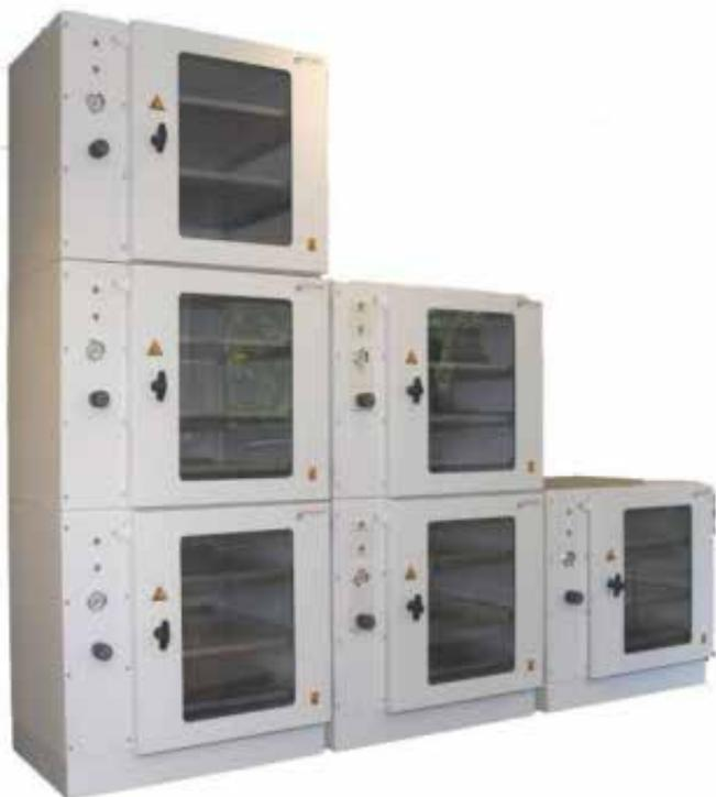
DryP Cabinet pour les équipements électroniques : stockage et séchage des composants sous azote - Photo Air Liquide
