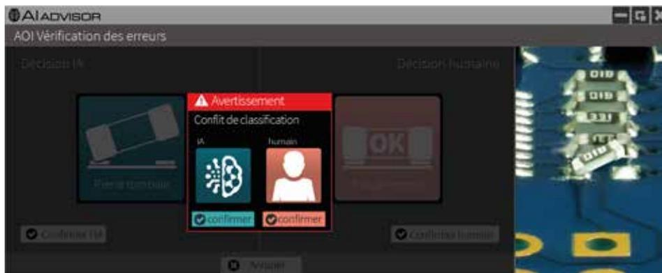
Un autre domaine dans lequel l'IA a une grande influence est la classification des erreurs. L'IA peut évaluer automatiquement les anomalies à l'aide de modèles pré-entraînés, afin de réduire la charge de travail du personnel. En même temps, on travaille continuellement à l'extension des fonctionnalités de l'IA afin de maximiser les économies de temps et d'argent.
