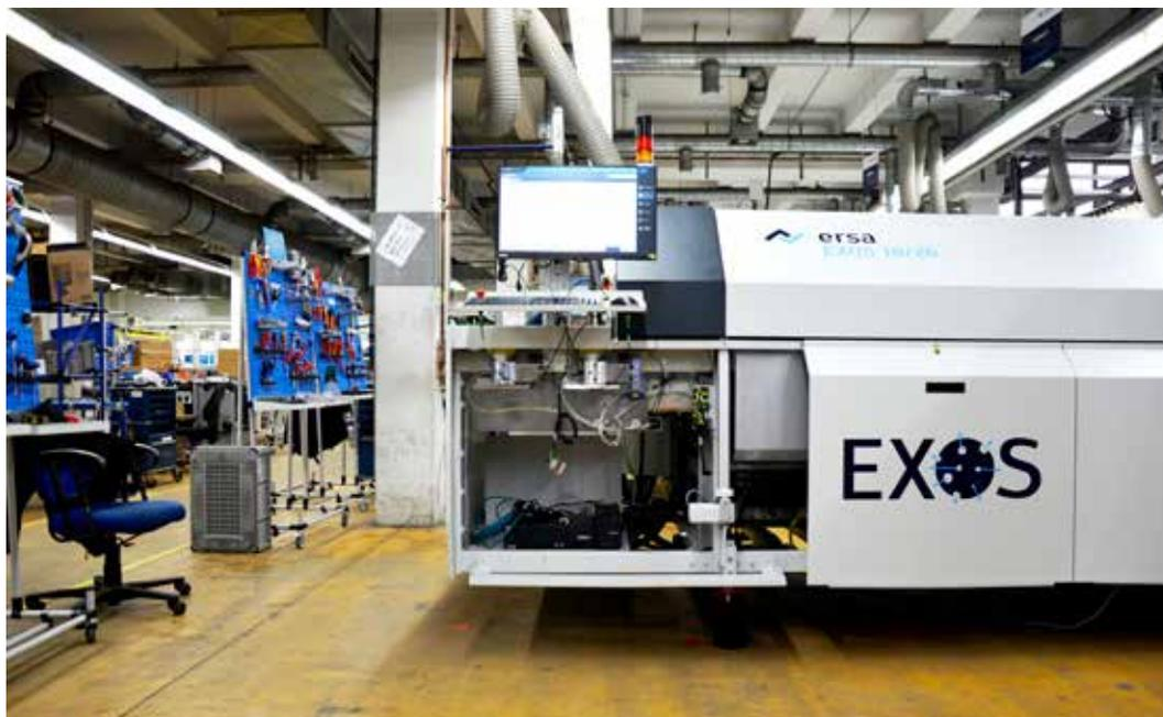
Tout est prêt sur le banc d'essai pour la réception par le client de l'installation de brasage par refusion EXOS 10/26
