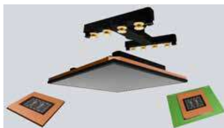
Le module OSC optimisé peut traiter des composants jusqu'à 200 × 150 mm et pesant jusqu'à 500 g.
